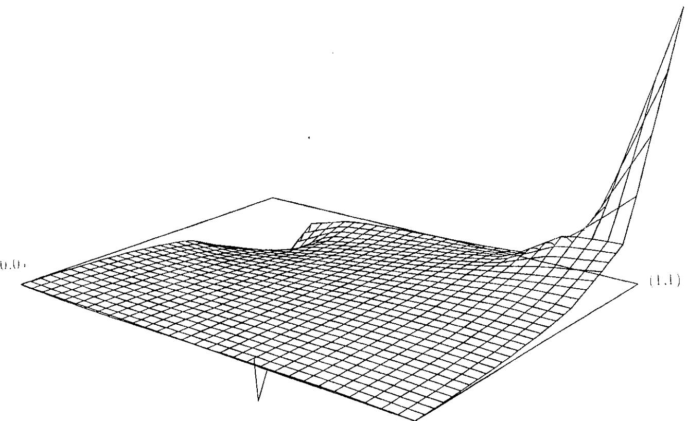
elemento Q2/Q1, ramp cavity, malha regular, 8x8 elementos
