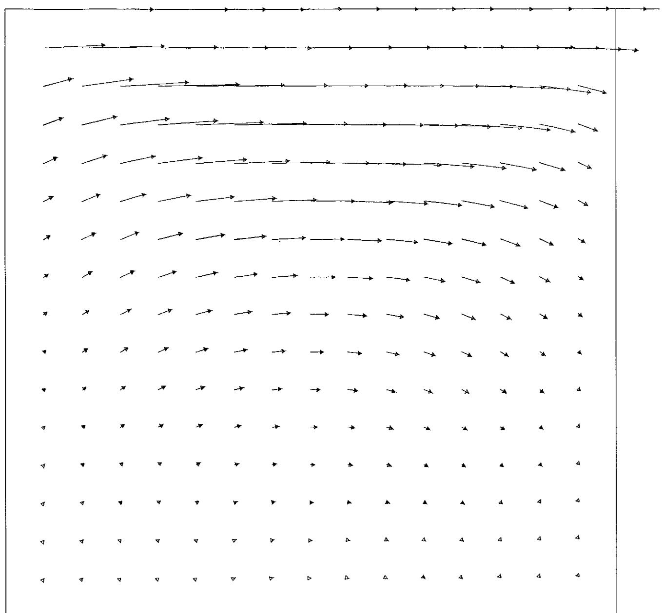
elemento Q2/Q1, ramp cavity, malha regular, 8x8 elementos
