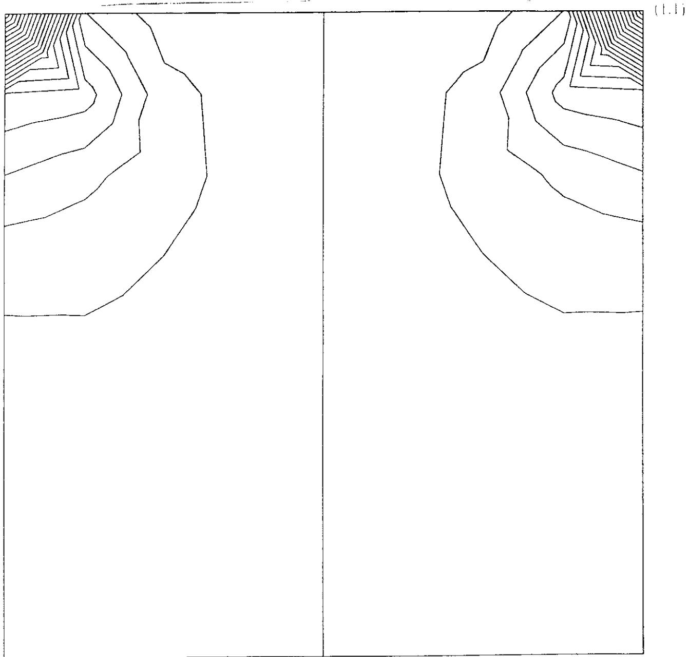
elemento Q2/Q1, ramp cavity, malha regular, 8x8 elementos
