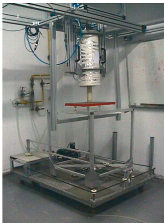
Fig. 1 Esquema experimental usado na obtenção de imagens magnéticas usando a técnica SSQUID.
